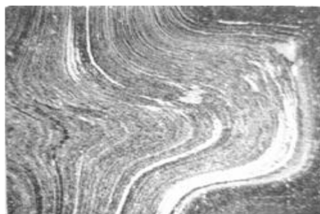
Fig. 3.12. Segregația fosforului și linii de deformare plastică evidențiate cu reactiv Oberhoffer
