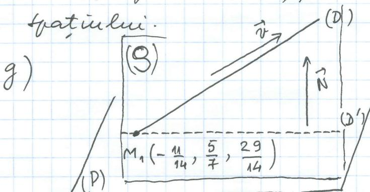
Proiecția  $D'$  se află la intersecția planului  $(P)$  cu planul  $S$  care conține dreapta  $(D)$  și este perpendiculară pe planul  $(P)$ .  $(S)$  se numește plan proiectant.  $(S)$  trece prin  $M_1$  - punctul de intersecție a dreptei  $(D)$  cu planul  $(P)$ .  $\vec{v}$  și  $\vec{N}$  sunt paralele cu  $\vec{v}$  și  $\vec{N}$ .
